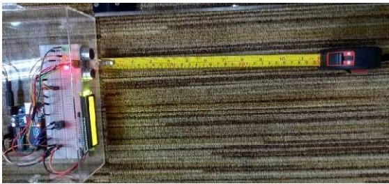
Gambar 13. Proses Pengujian Sensor 30 cm Sumber: Peneliti, 2024
