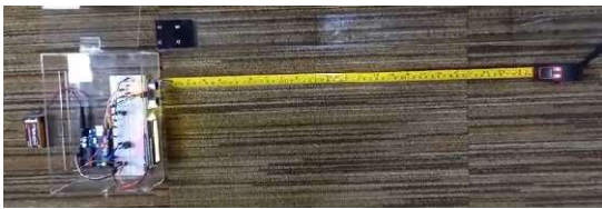
Gambar 15. Proses Pengujian Sensor 30-60 cm Sumber: Peneliti, 2024
