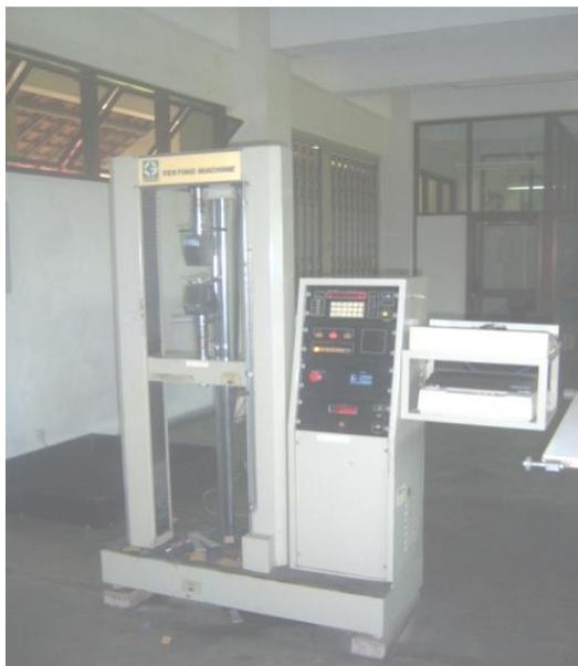
**Gambar 3.1. Mesin Uji Tarik Komposit**
