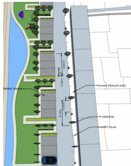
Gambar 33. Denah Perancangan Ruang Jalan
